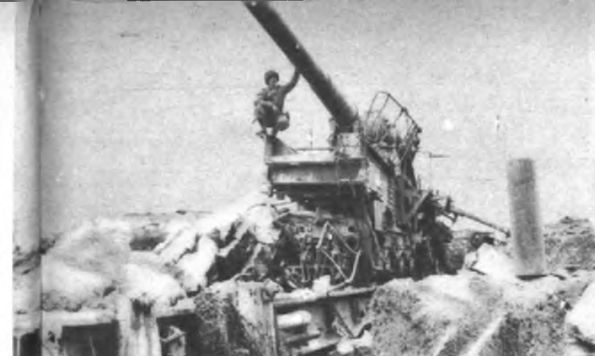
Oto 16-cio calowe działo niemieckie zmontowane na specjalnej platformie. Całość stała się po szynach kolejowych, umieszczonych w wybetonowanym rowie. Działo to miały unieszkodliwić floty Sprzymierzonych na Kanale angielskim.
